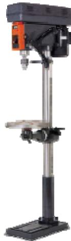
Сверлильный станок имеет ход шпинделя 80мм и максимальный диаметр сверления 16мм. Станок используется для сверления глухих и сквозных конических и цилиндрических отверстий, для снятия фасок, зенковки, развертывания, расточки и рассверливания. Станок имеет головку для сверления с панелью управления, колонну большого диаметра с толстыми стенками, стол с крепежными радиальными пазами, литое основание и зубчатый механизм, перемещающий головку и стол.
