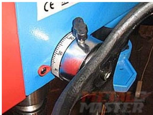
Пиноль подается при помощи ручки в форме звезды. На станке также расположен указатель глубины сверления с выставлением точки отсчета при необходимости.
