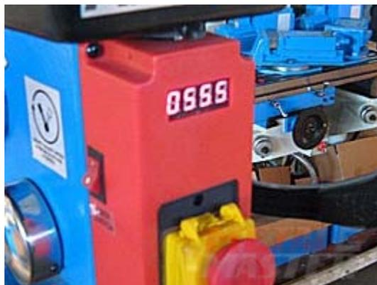
Плавный ход высокой точности обеспечивается шкивами из алюминия со шлифовкой и приводными зубчатыми ремнями. Скорость вращения может регулироваться без ступеней путем поворота ручки, расположенной сбоку от сверла. Частота оборотов демонстрируется на цифровом индикаторе.
