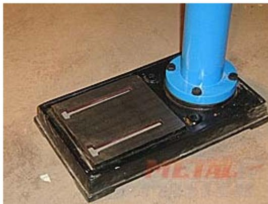
Отсек с инструментами располагается на колонне. При работе с заготовками больших размеров стол отводят в сторону и закрепляют детали на опорной плите в виде прямоугольного стола с пазами.
